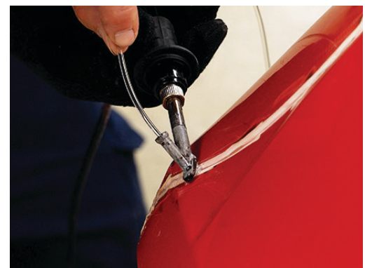
Utilice el soldador sin aire para nivelar soldaduras con aire caliente o para reparar parachoques y laterales de camiones de poliuretano termoestable (PUR) con la varilla de soldadura incluida.
