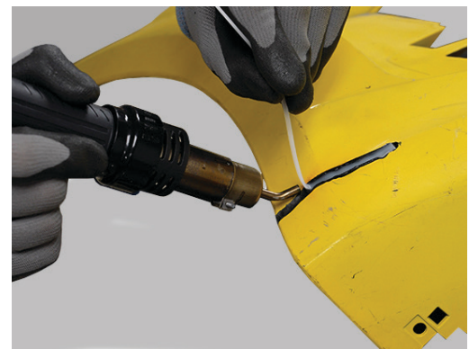
Utilice el soldador de aire caliente para realizar soldaduras rápidas y resistentes en termoplásticos con las varillas de cinta incluidas
